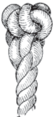
FIG. 116.—Wall knot (tucked).
